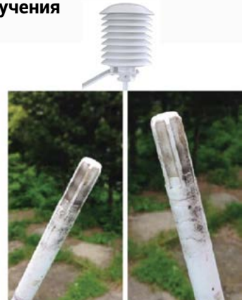
Значительное накопление грязи, характерное для всех многопластинчатых конструкций солнечной радиации, за тот же период времени
